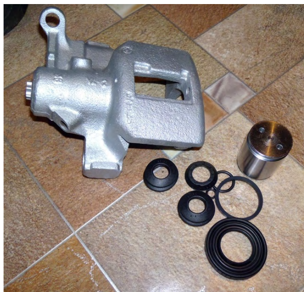
Суппорт после покраски
