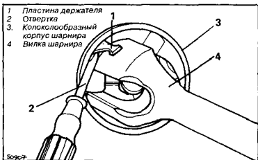
Рис. М:22 Выведение пластин звездообразного держателя из зацепления с вилкой шарнира
